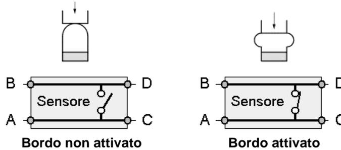
Il bordo sensibile GR-748 è conforme alla normativa EN 13856-2. In abbinamento al modulo di controllo PS3-Ax può raggiungere la CAT 3 - PL e della ISO 13849-1. Considerare questo valore per il calcolo del PL totale della macchina dove questo dispositivo di sicurezza è installato.
