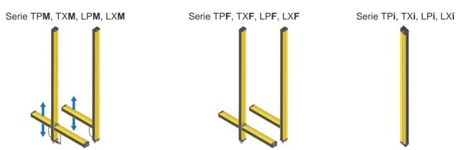
Possono essere fornite in configurazione **T** per il controllo di ingresso e uscita, oppure **L** per il controllo della sola uscita. I sensori possono essere in configurazione **parallela** o **incrociata**.
