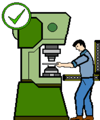
Protezione orizzontale e verticale
